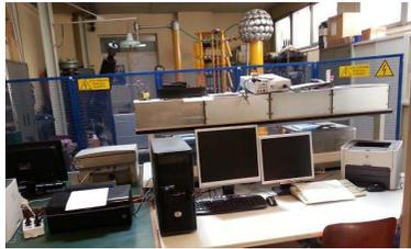
In questo laboratorio si svolgono prove di tenuta elettrica, in diverse condizioni, su componenti elettrici. In particolare è disponibile un generatore in alta tensione impulsiva sino a 600 kV.
